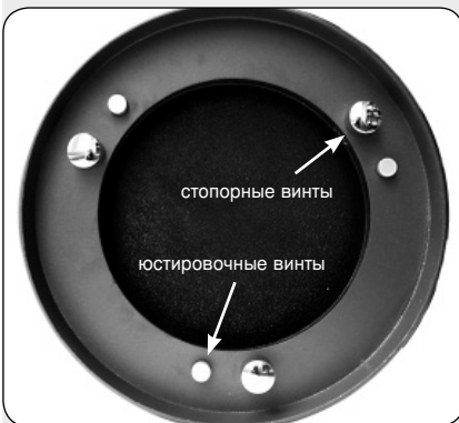
Рис. 31с: Шесть юстировочных винтов на крышке главного зеркала
