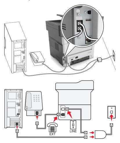
Линия DSL разделяет обычную телефонную линию на два канала: голосовой и Интернет. Сигналы телефона и факса передаются по голосовому каналу, а сигналы Интернета – по другому. Таким образом одну линию можно использовать для аналоговых голосовых вызовов (включая факсы) и для цифрового доступа в Интернет.
