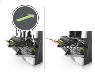
**8** Установите картридж с тонером, совместив стрелки на боковых направляющих картриджа со стрелками на боковых направляющих внутри принтера, а потом вставьте картридж в принтер.
