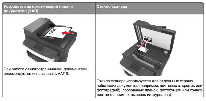
Принтер можно использовать для передачи отсканированных документов по электронной почте одному или нескольким получателям. Сделать это можно тремя способами. Можно ввести адрес электронной почты, использовать номер кода быстрого доступа или адресную книгу.
