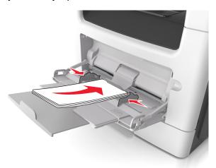
**ПРЕДУПРЕЖДЕНИЕ. Возможность повреждения:** Не используйте конверты со штампами, зажимами, застежками, окнами, подкладкой и самоклеющимися деталями. Использование таких конвертов может привести к серьезному повреждению принтера.
