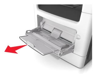
**б** Осторожно вытащите раскладную часть таким образом, чтобы полностью выдвинуть и открыть многоцелевое устройство подачи.
