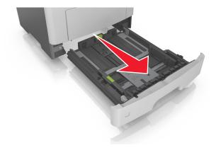
**2** Сожмите, а затем передвиньте направляющую ширины в положение, соответствующее формату загружаемой бумаги.
