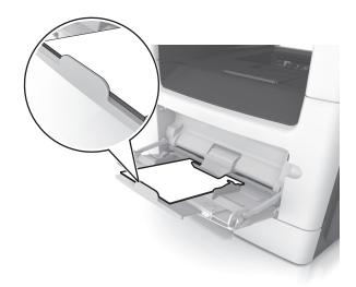
• Фирменные бланки следует загружать лицевой стороной вверх, верхним краем к принтеру. Для выполнения двусторонней печати фирменные бланки следует загружать лицевой стороной вниз, нижним краем к принтеру.
