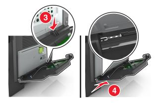
**11** Протяните кабель ISP через дверцу защитного чехла системной платы.
