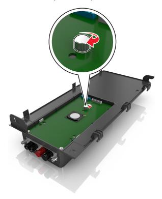
**7** Затяните два винта на конце решения ISP.
