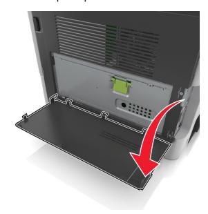
2 Слегка нажмите фиксатор на левой стороне дверцы доступа, а затем сдвиньте дверцу доступа.
