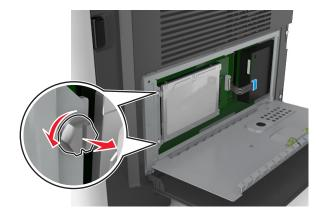
**3** Отсоедините интерфейсный кабель жесткого диска принтера от разъема платы контроллера, оставив кабель подключенным к жесткому диску принтера. Прежде чем отсоединить кабель, сожмите лепестки на разъеме интерфейсного кабеля, чтобы разблокировать фиксаторы.
