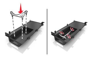
**5** Сдвиньте и втолкните решение ISP внутрь пластикового вкладыша.
