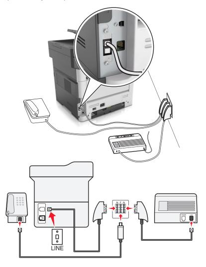
1 Подсоедините один разъем телефонного кабеля, прилагаемого к принтеру, к порту 🖹 на задней панели принтера.
