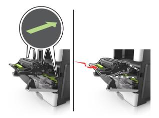
**7** Установите картридж с тонером в принтер, совместив стрелки на боковых направляющих картриджа со стрелками на боковых направляющих внутри принтера.
